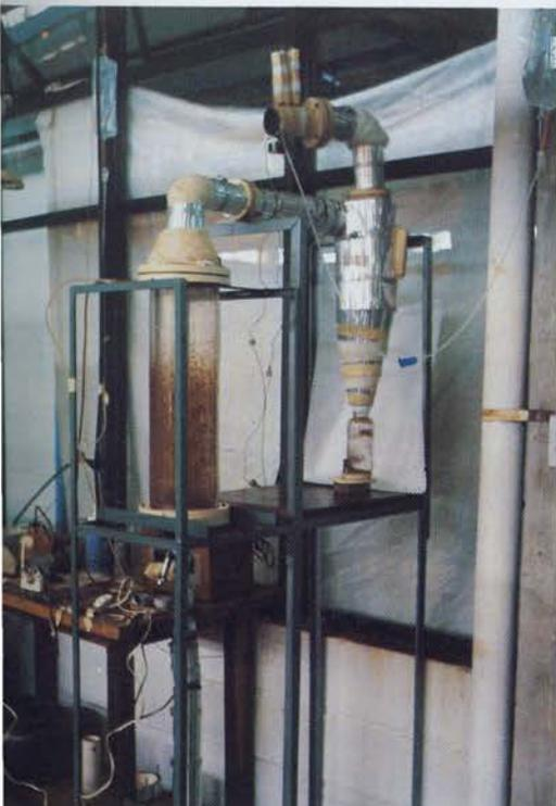
Fig. 1 — O equipamento "leito de jorro" que está sendo utilizado na Universidade Federal de São Carlos para secagem de sangue bovino.
