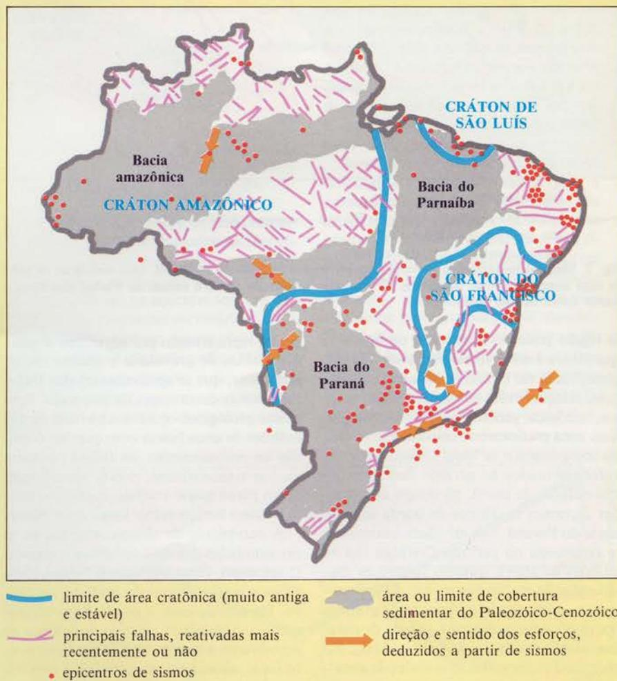
Fig. 6. Mapa sismotectônico (simplificado) do Brasil. Note-se a variação das direções dos esforços compressivos em áreas de embasamento e cobertura sedimentares, bem como a ocorrência de sismos em áreas cratônicas, de sedimentos fanerozóicos e em faixas de dobramentos. As estruturas geológicas da área das bacias sedimentares não foram representadas porque são inexpressivas em relação às áreas de embasamento (crátons e faixas de dobramentos pré-silurianos).
