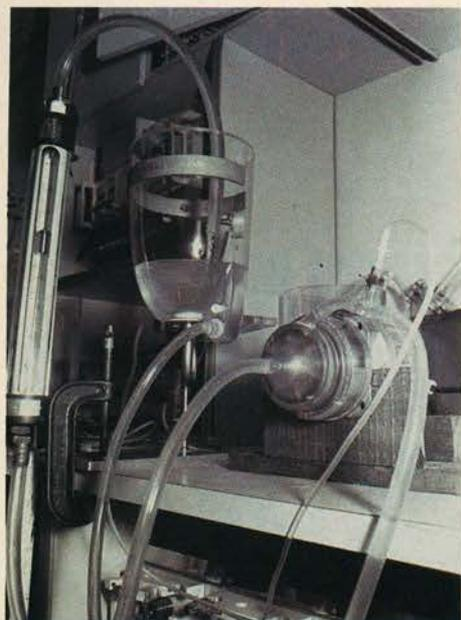
**Figura 2. A bomba centrífuga é adequada para substituir o coração por períodos curtos, como cirurgias mais prolongadas que a média.**
