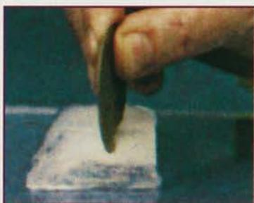
**Demonstração da condutividade de diamantes sintéticos: o calor emanado do corpo humano é transferido ao diamante, capacitando-o a cortar o cubo de gelo**
