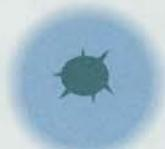
Cada uma dessas fendas sofre a ação de tensões que tendem a abri-las cada vez mais. No desenho abaixo, mostramos o detalhe do buraco e uma fenda, indicando por setas as forças que tendem a abri-la. Elas funcionam como alavancas que forçam a abertura: elas rasgam a borracha do balão.
