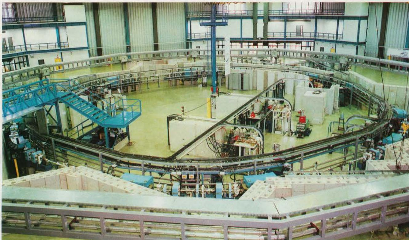
**Figura 2.** Anel de armazenamento de elétrons do LNL. Seu diâmetro médio é de 30m. A área acessível aos usuários permite que sejam instaladas 'saídas' (ou linhas de luz) desse anel de até 33m de comprimento.
