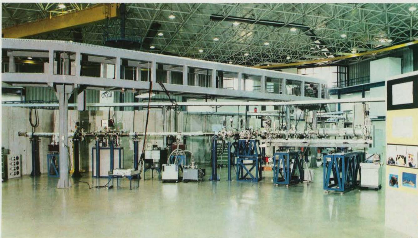
**Figura 7.** Parte do anel do LNLs no qual se produz radiação empregada na técnica denominada espalhamento de raios X. Essa linha de luz tem 16 m de comprimento.
