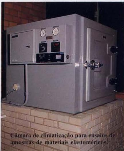
Câmara de climatização para ensaios de amostras de materiais elastoméricos.
