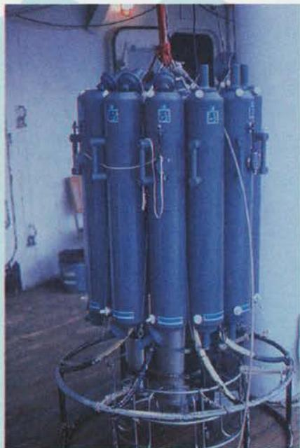
Equipamento usado para coletar amostra do fundo do mar.
