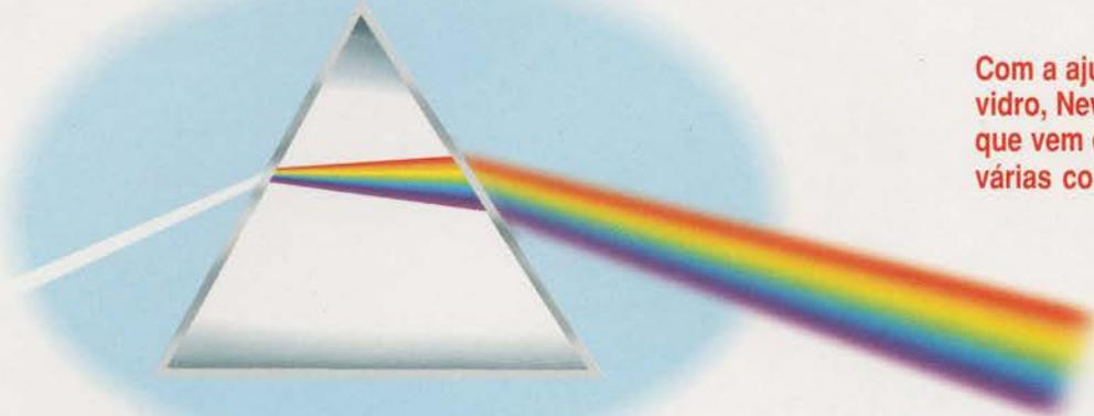
Com a ajuda de um prisma de vidro, Newton mostrou que a luz que vem do sol é formada por várias cores.
