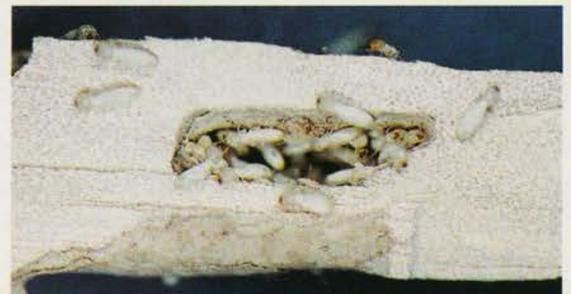
**Figura 1.** Pedaco de madeira com infestação por cupim subterrâneo
