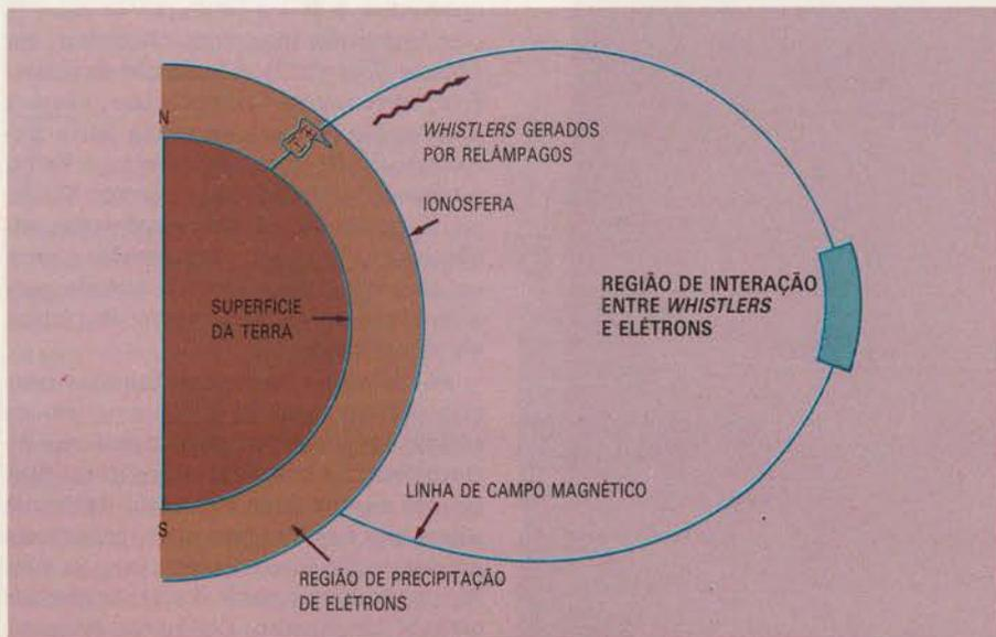
Fig. 9. Esquema da interação entre whistlers e elétrons, ao longo das linhas do campo magnético da Terra.
