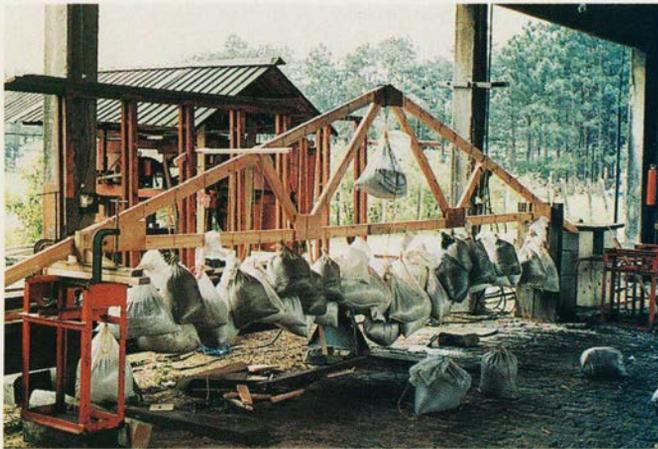
**Figura 2. Teste de carga, com sacos de areia, em estrutura construída com eucalipto, no IPT.**
