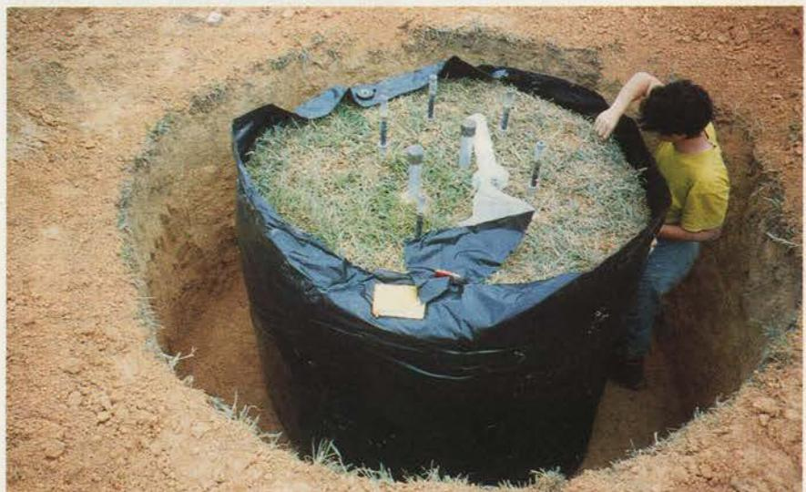
**Figura 9. Medição da variação da permeabilidade do solo à água em área de pastagem, na fazenda Dimona, perto de Manaus.**
