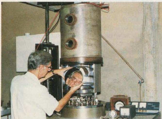
**Figura 3.** Com peças de ferro-velho e uma velha máquina herdada de uma multinacional, Riedel construiu uma câmara de vácuo para aplicar películas de filme fino em superfícies ópticas.
