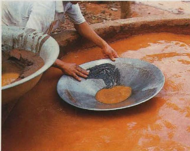
**Figura 15.** Em alguns garimpos, o processo de amalgamação já é feito em sistema fechado, em princípio sem contaminação ambiental.
