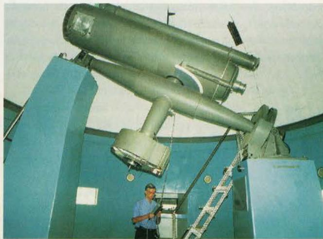
**Figura 4.** O telescópio refrator do Observatório Astronômico da Escola de Minas de Ouro Preto (MG), dotado de lentes de 200mm de abertura, restaurado por Riedel e hoje em pleno funcionamento.
