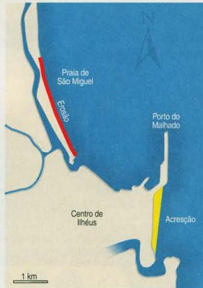
**Figura 7. O Porto do Malhado, em Ilhéus (BA), interrompeu a deriva litorânea, provocando erosão ao norte, associada a grande acresção ao sul.**
