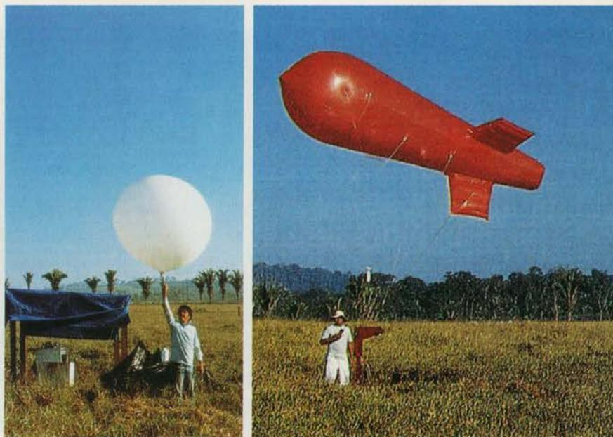
**Figura 13. Radiossondas (à esquerda) e balões cativos foram utilizados para medir as propriedades atmosféricas. As primeiras alcançam até 15km de altitude, enquanto os balões podem fazer medições detalhadas até 1km.**
