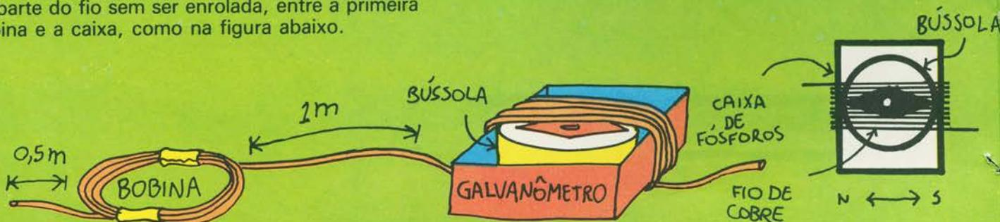
3. Com a lâmina de barbear, raspe as duas extremidades do fio, tirando todo o esmalte. Enrole uma ponta do fio na outra.
