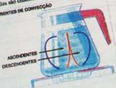
Propagação por convecção é, portanto, a propagação de calor através da matéria em movimento. Ocorre nos líquidos e nos gases, pois neles as moléculas se deslocam com relativa facilidade. As correntes de vento, ascendentes e descendentes, que se formam na atmosfera, também transmitem calor através do movimento das moléculas do ar.
