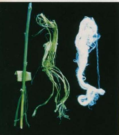
**Figura 1. Três etapas do processo de produção da fibra de rami: o caule da planta, de onde se retiram as cascas para extrair a parte fibrosa, a fibra em estado bruto e beneficiada pelo processo enzimático.**
