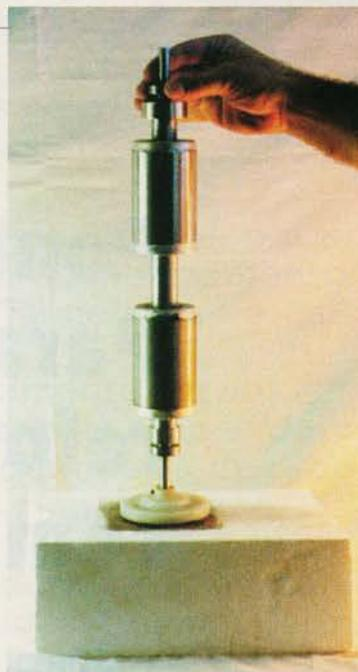
**A tecnologia desenvolvida na UFRJ não usa eletricidade para fazer o trem levitar. A foto mostra um rotor duplo levitando sobre blocos supercondutores**
