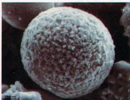
FIGURA 5. Partícula de cinza volante do carvão de Candiotá (microscopia eletrônica).
