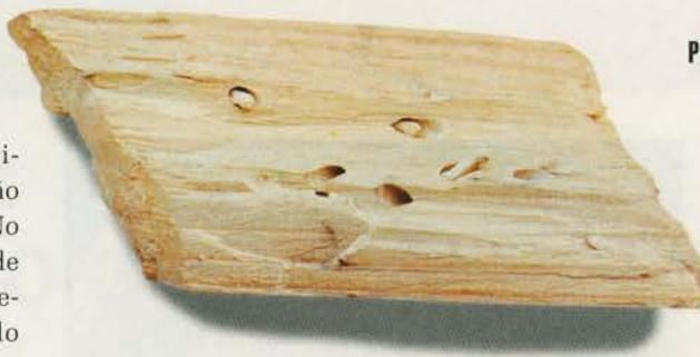
**Figura 2.** As larvas de *S. noctilio* fazem galerias dentro dos troncos, o que reduz a qualidade da madeira
