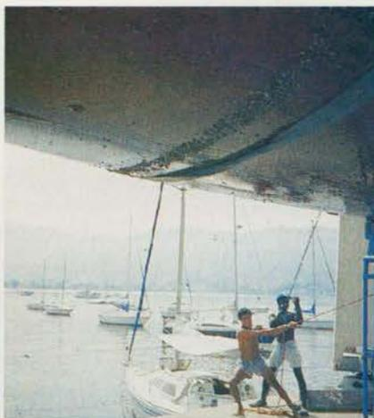
**Figura 2. Incrustação biológica em casco de embarcação, destacando-se a presença de cracas, apenas na faixa em que a tinta antiincrustante foi danificada (à esquerda).**
