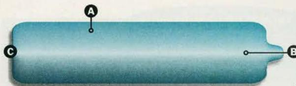
**Figura 6. Tubo de raios catódicos de Lenard, construído em vidro, vendo-se os eletrodos negativo (A) e positivo (B) e a 'janela' de alumínio (C).**
