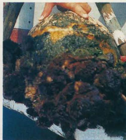
**Figura 3. Incrustação biológica em estado avançado em bóia de ancoragem (à direita).**
