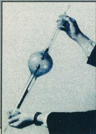
**Figura 11.** Tubo de vácuo de Coolidge, semelhante aos utilizados até hoje em aparelhos medicinais de raios X.
