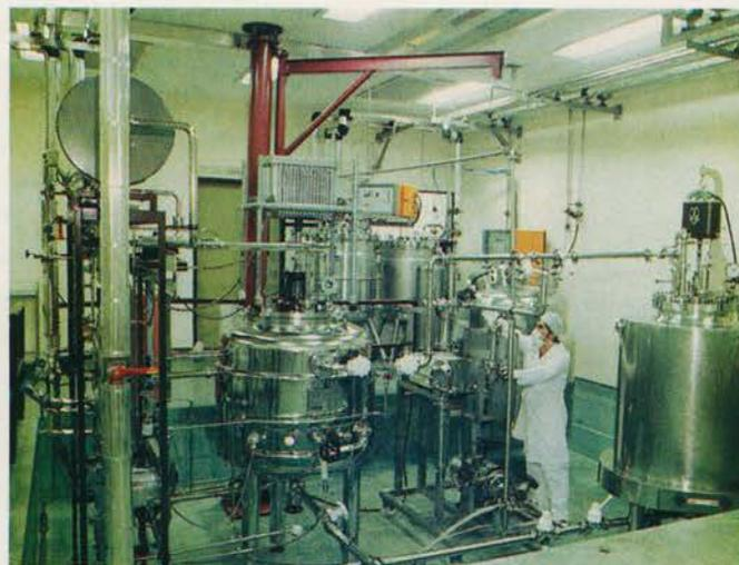
**FIGURA 5. EQUIPAMENTO DE PROCESSAMENTO PARA PRODUÇÃO DE VACINA ANTITÉTANICA. NA FOTOGRAFIA, PODE-SE OBSERVAR, À DIREITA, O RECIPIENTE QUE CONTÉM O MEIO DE CULTURA, O FERMENTADOR DE GRANDE PORTE (500L) E ACIMA DELE O FILTRO TANGENCIAL.**
