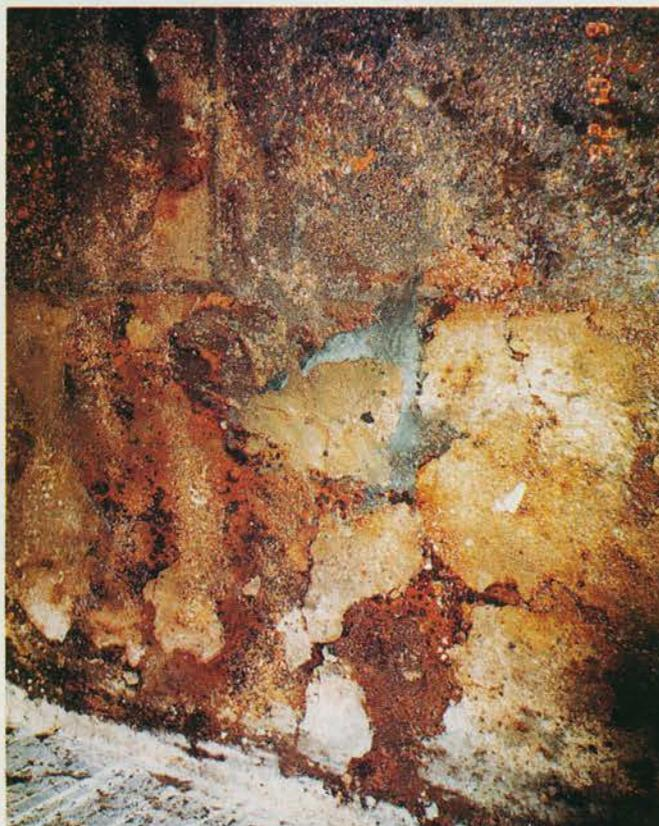
**FIGURA 1. CORROSÃO UNIFORME NA PAREDE DO PORÃO DE UM NAVIO GRANELEIRO.**
