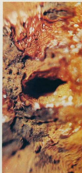
**FIGURA 3. CORROSÃO EM FORMA DE ALVÉOLO, COMUM NO FUNDO DE NAVIOS PETROLEIROS.**
