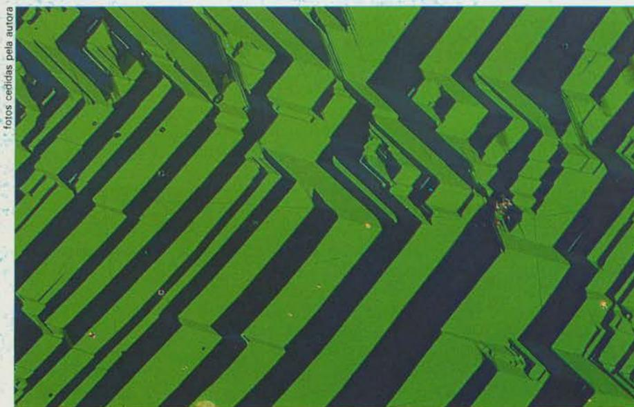
Fig. 1. Arranjo típico das placas de martensita em ligas de cobre-zinco-alumínio com efeito de memória de forma. Foto obtida por microscopia óptica com luz polarizada. Cada cor representa uma orientação cristalográfica distinta.
