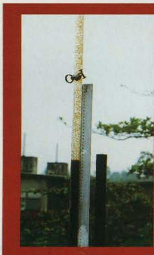
**Figura 2.** (Foto da esquerda). No tubo exposto à luz solar - parte da planta-piloto do experimento - acontece a oxidação do ferro em solução e sua precipitação em forma de flocos.
