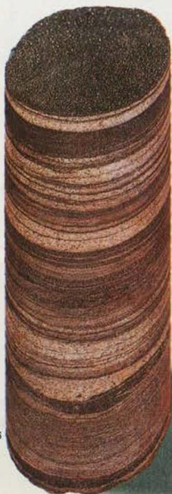
**Figura 1. A amostra do itabirito encontrado nas jazidas ferríferas de Minas Gerais mostra claramente as camadas alternadas de ferro e sílica típicas dessa rocha.**
