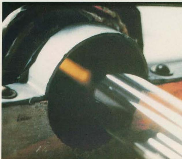
**Figura 4. Saída do magneto, quando o feixe atômico é obrigado a parar pela força da radiação. A interrupção da luz amarela emitida pelos átomos demonstra a posição na qual o feixe está atingindo o repouso.**
