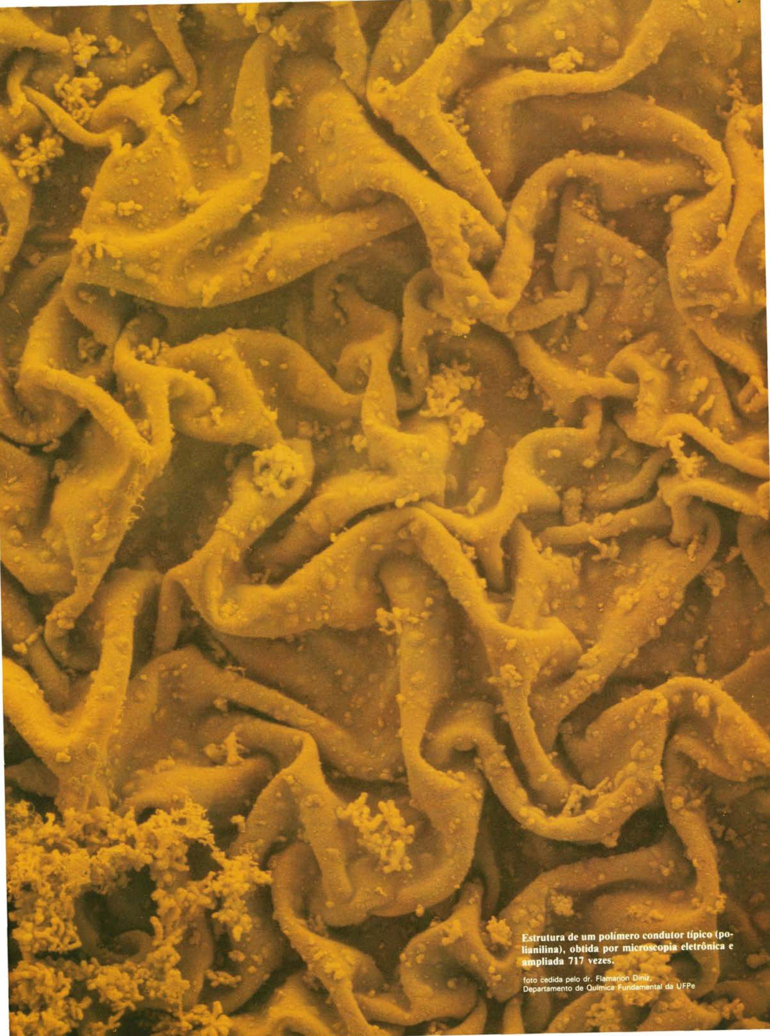
Estrutura de um polímero condutor típico (polianilina), obtida por microscopia eletrônica e ampliada 717 vezes.
