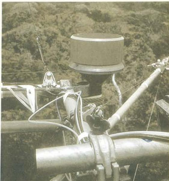
Pluviômetro (para medidas de precipitação).
