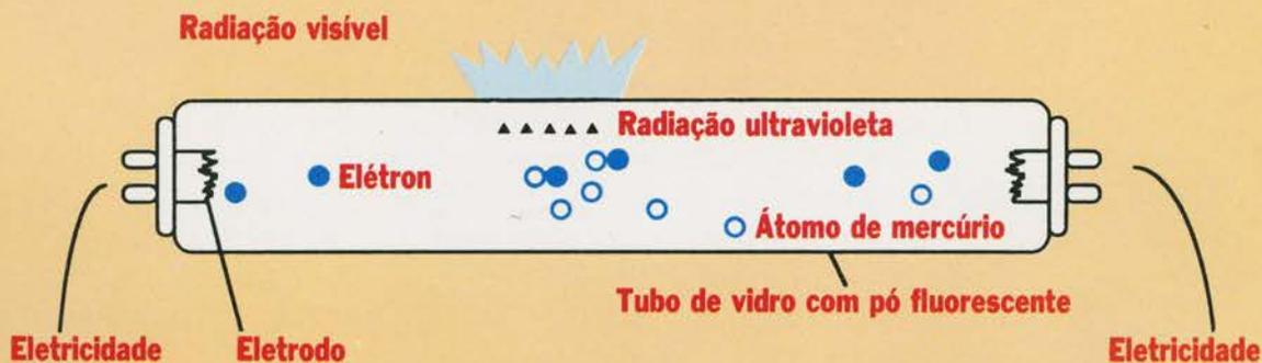
*Princípio do funcionamento de uma lâmpada fluorescente tubular. Os elétrons e os átomos de mercúrio colidem. Os átomos de mercúrio energizados liberam radiação ultravioleta, entrando em contato com a superfície fluorescente do tubo de vidro, produzindo a luz.*
