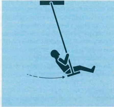
As oscilações do balanço têm uma frequência natural que depende apenas do seu comprimento e da aceleração da gravidade.
