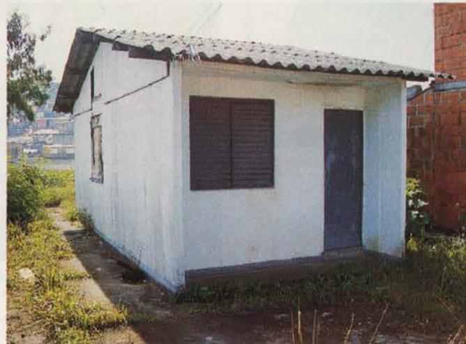
**Figura 1. Casa popular, feita com painéis pré-moldados de 'supercimento' formado pela mistura de escória de alto-forno, areia, gipsita, cal-hidratada e fibra de coco, construída no bairro de Vila Nova Cachoeirinha, SP.**
