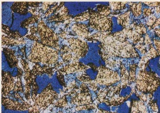
**Figura 3. Fotomicrografia (aumento de 38 vezes) do cimento natural, com uso do corante azuloracet. Os testes em laboratório mostraram a ação cimentante da sílica coloidal (em azul claro) sobre a areia (em amarelo).**
