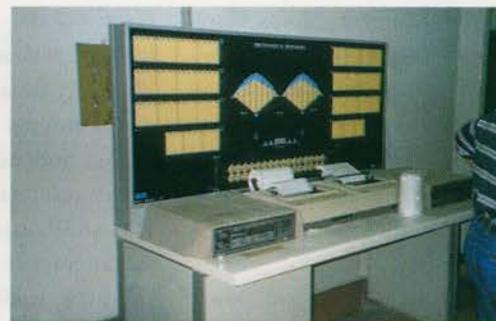
**Figura 4. Painel de controle de sistema de termometria.**
