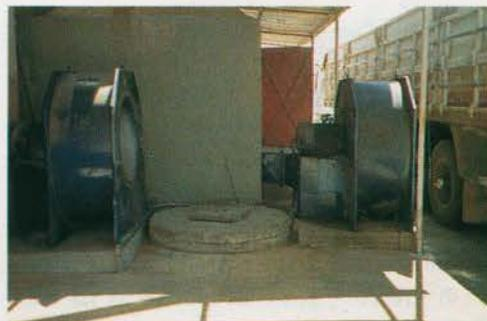
**Figura 3. Ventilador centrífugo utilizado em sistema de aeração de grãos armazenados.**
