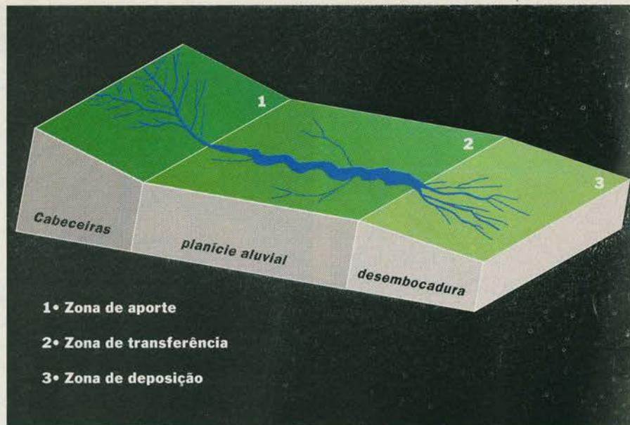
Figura 1. Representação esquemática das três áreas que compõem o sistema fluvial.
