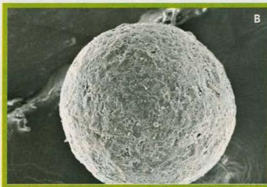
**Figura 6.** Cristais irregulares (A) de droga anti-inflamatória (produto comercial, com aumento de 5 mil vezes), e a mesma droga (B) dentro de microesferas (aumentadas 400 vezes) produzidas por cristalização e microencapsulação simultâneas, o que permite sua liberação controlada
